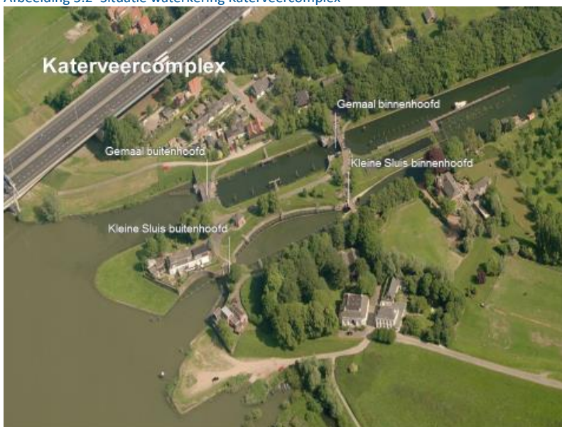
Afbeelding 3.2 Situatie waterkering Katerveercomplex
