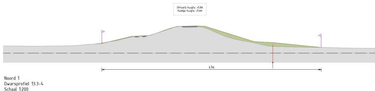
Afbeelding 8-63: Representatief dwarsprofiel deeltraject 13.3
