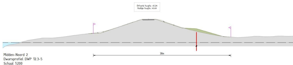
Afbeelding 8-51 Representatief dwarsprofiel deeltraject 12.3
