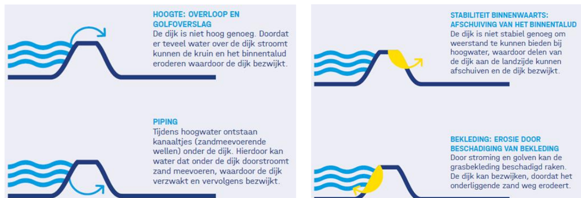
Afbeelding 2-1 Toelichting belangrijkste faalmechanismen voor IJsselwerken
