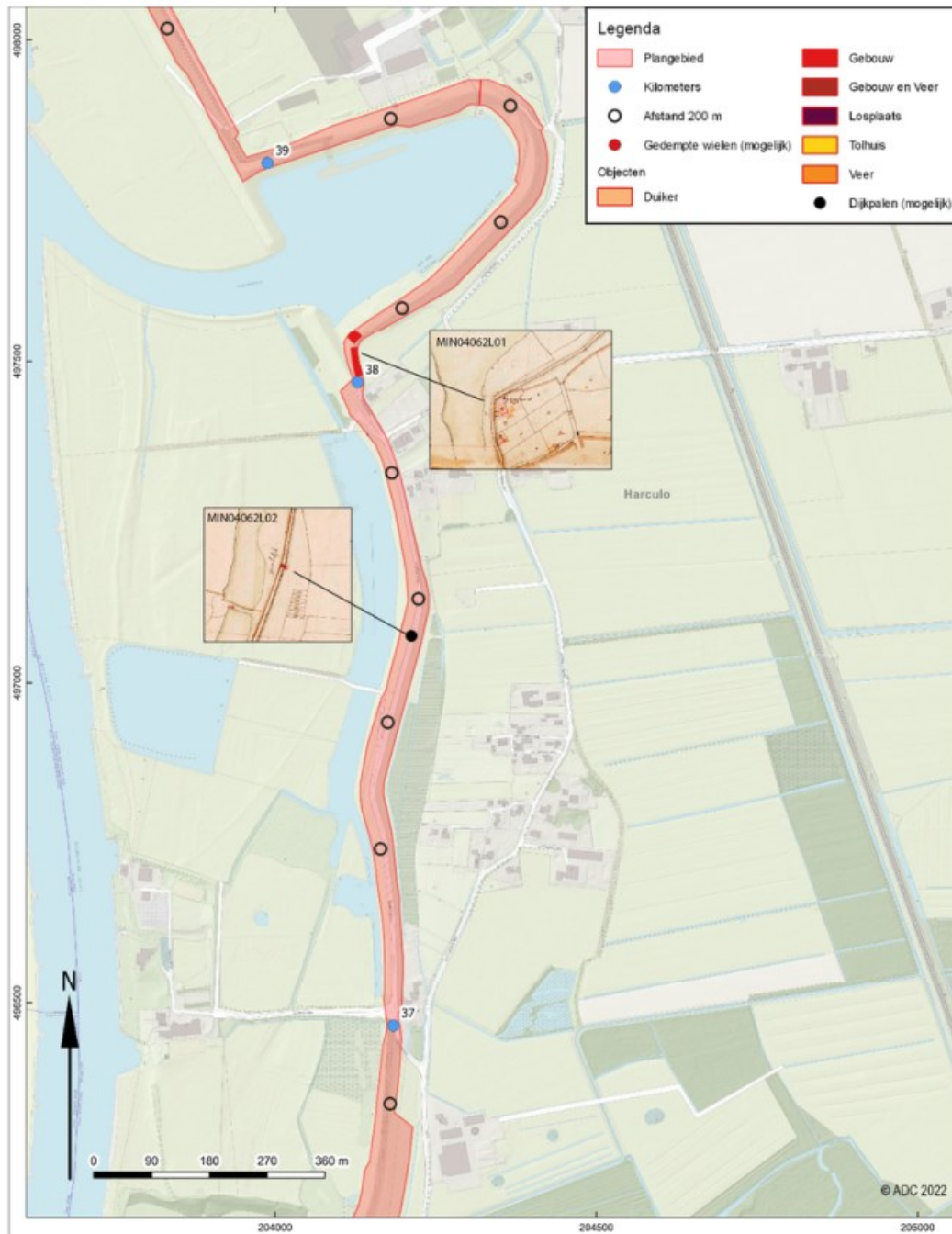
Afb. 18 Zones met dijkgerelateerde structuren
