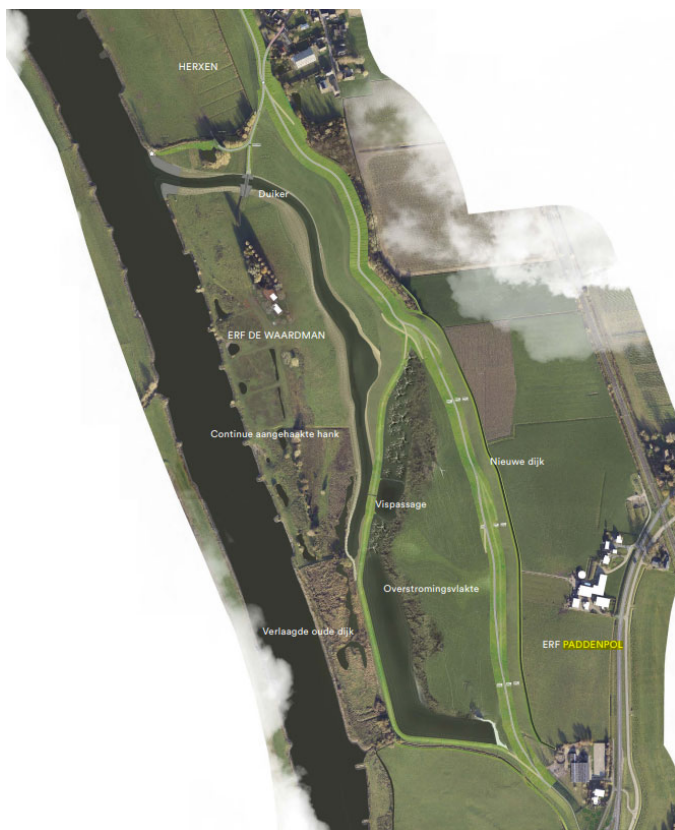
Afbeelding 5: Ligging van de nieuwe verlegde en de verlaagde oude dijk, de continue aangehaakte en de laag dynamische hank.
