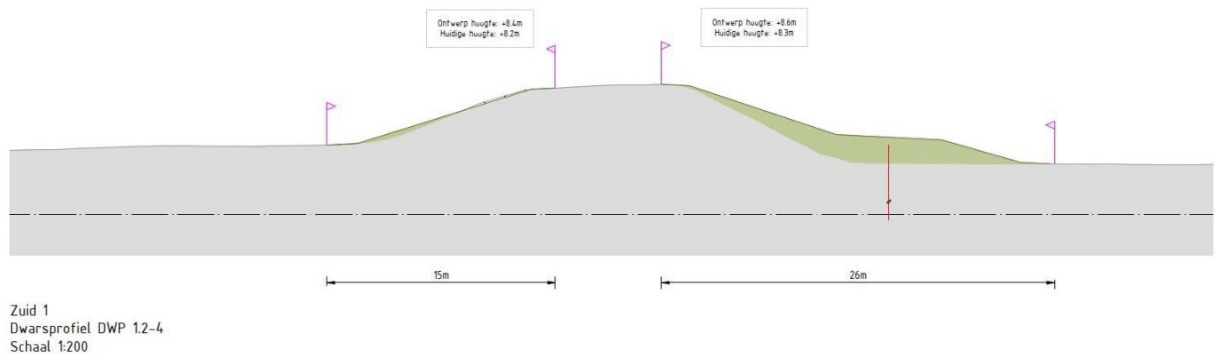
Afbeelding 2: Representatief dwarsprofiel deeltraject 1.2
