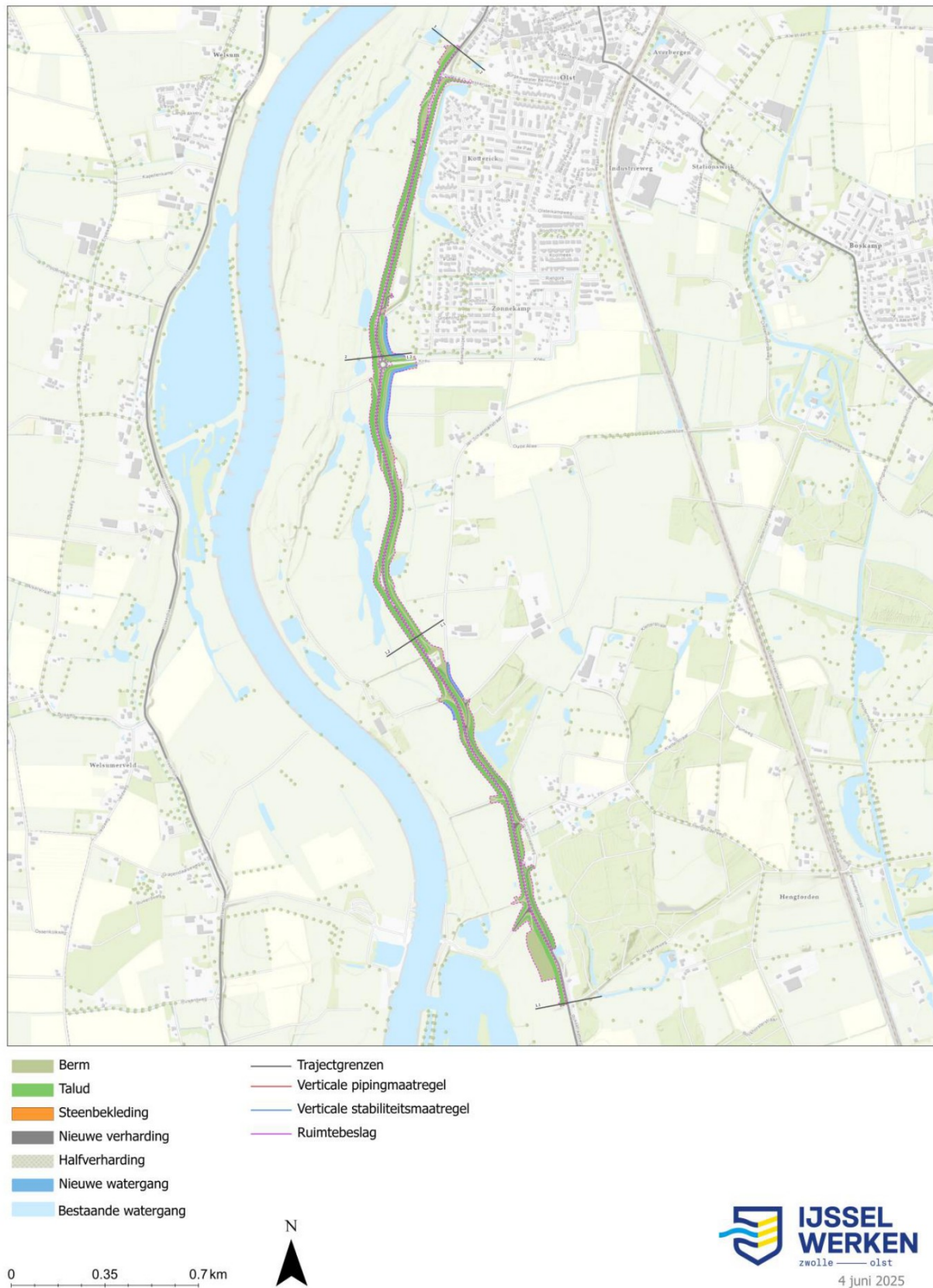
Afbeelding 4: Dijkversterkingsontwerp dijkmodule Zuid 1
