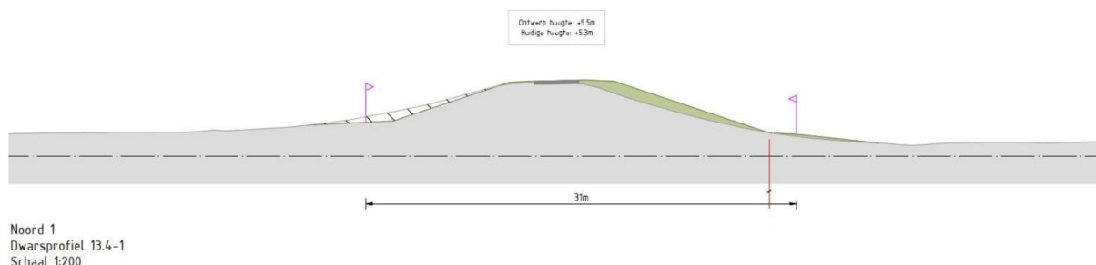
Afbeelding 55: Representatief dwarsprofiel deeltraject 13.4
